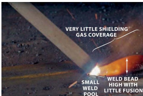
(ก) การเชื่อมด้วยกระแสที่ต่ำเกินไป
