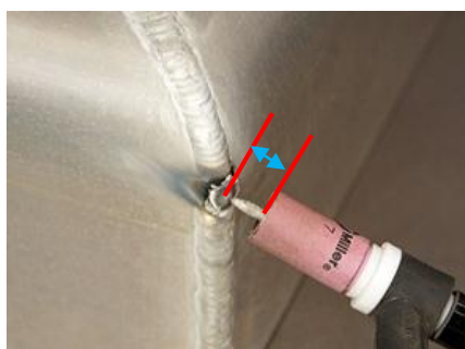
(ข) ระยะยื่นลวดทั้งสแตนแบบเชื่อมขอบ
