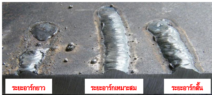
รูปที่ 5.7 ลักษณะรูปร่างของแนวเชื่อมที่เชื่อมด้วยระยะอาร์กที่แตกต่างกัน
