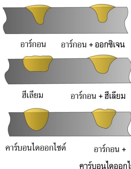
รูปที่ 5.40 รูปร่างกับระยะการซึมลึกของแนวเชื่อมที่เลือกใช้แก๊สปกคลุมต่างชนิดกัน
